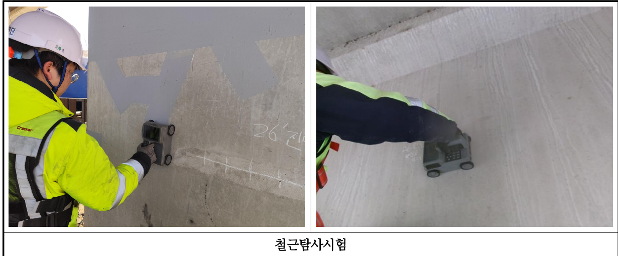
【사진 3.36】 철근탐사시험 현장사진
